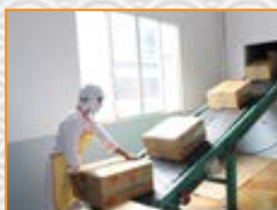
Băng tải tự vận chuyển bánh Automatic conveyor belt
