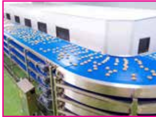
Tháp làm nguội bánh pía Pia cake cooling tower 榴莲饼冷却塔
